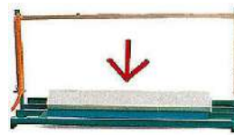
Schneiden von Dämmstoffkeilen
