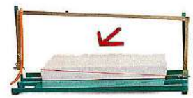
Schneiden von Gefälleplatten
